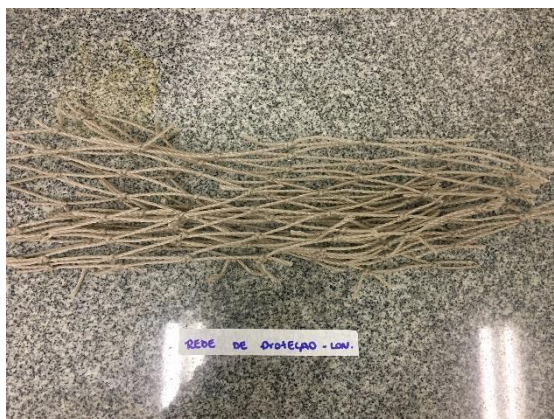
Foto 1. Amostra Longitudinal antes do intemperismo.
