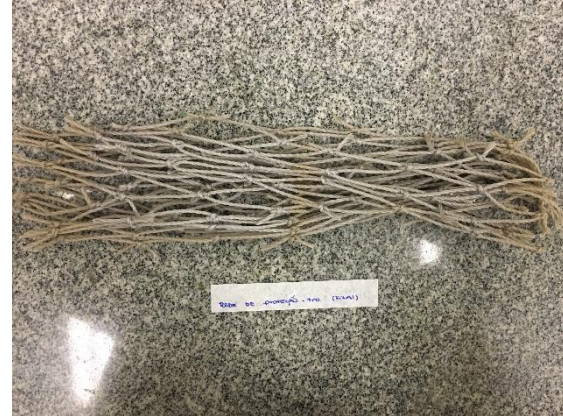
Foto 4. Amostra Transversal após intemperismo.
