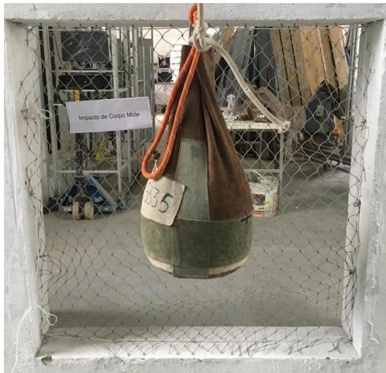
Foto n.º 01 – Visualização do ensaio de resistência ao impacto
