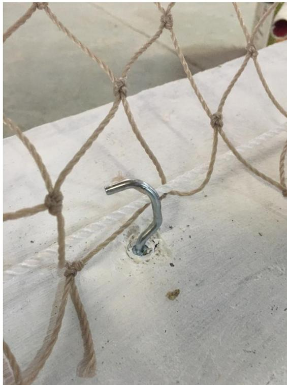
Foto n.º 02 – Visualização do ensaio após o impacto de corpo mole – Afrouxamento dos ganchos de fixação.
